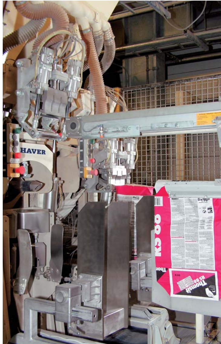
Sistema de ensacagem para sacos valvulados totalmente automático com aplicação e selagem dos sacos
