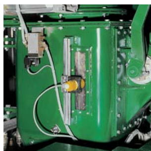
Câmara de pressurização com visor e indicador de nível
