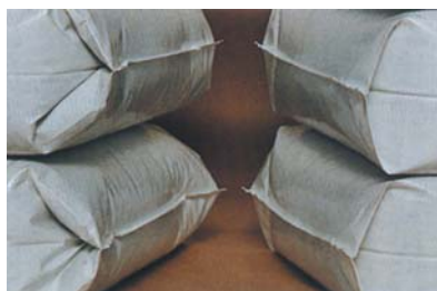
Sacos sem e com solda nas bordas
