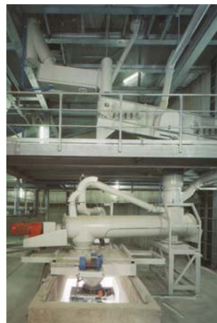
Tromba móvel com peneira de rejeito e sistema móvel com transporte helicoidal.
